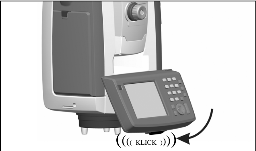
Figur 4.40 Fastsättning av kontrollenheten Trimble CU
