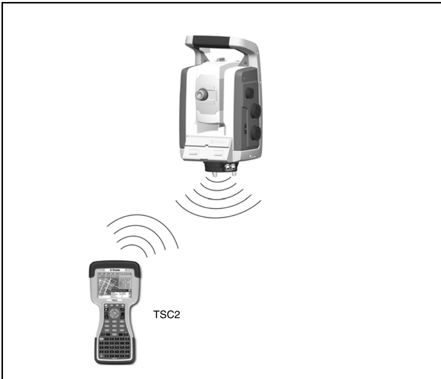
Figur 4.44 TSC2 ansluten till Trimble S med trådlös Bluetoothteknik för mätning med servo och autolock.
