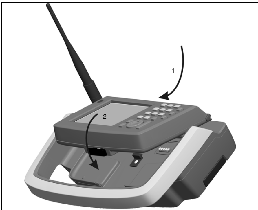
Figur 7.73 Sätta i kontrollenheten i hållaren
