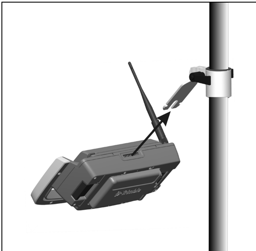
Figur 7.75 Fästa hållaren (Trimble Robotic Holder) vid stavens standardfäste.
